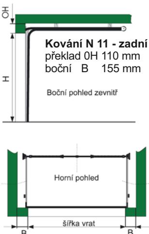
Vodící lišty garážových vrat jsou uchyceny zevnitř za vratovým otvorem vymezující vratovému křídlu vrat prostor pro pohyb (nahoru, dolů). Podle stavebních dispozic se rozlišuje vratové kování STANDARDNÍ, kdy výška nadpraží musí být minimálně 350 mm, NÍZKÉ v případě že výška nadpraží se pohybuje mezi 230 - 350 mm a NÍZKÉ s vyvažovacími pružinami vzdadlo pro případ, kdy nadpraží je v rozmezí 70 - 230 mm.
